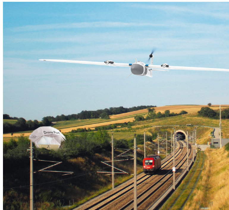
So könnte die Zukunft aussehen: Entlang des Streckennetzes der Deutschen Bahn werden Drohnenhangars stationiert, von wo aus Drohnen autonom zur Bewuchsanalyse auf einem bestimmten Gleisabschnitts aufbrechen
