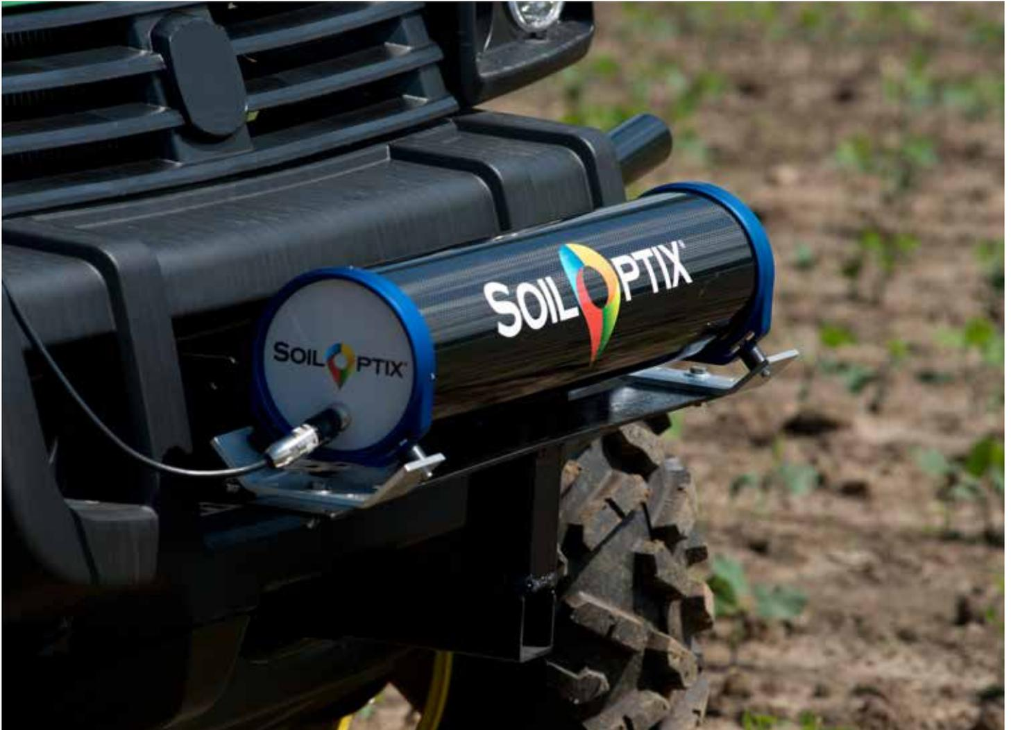
Der berührungslose Bodensensor SoilOptix® ermöglicht eine hochauflösende Kartierung des Oberbodens. Neben der Bodentextur werden Makro- und Mikronährstoffe, pH-Wert, organische Substanz und pflanzenverfügbares Wasser ermittelt. geoTOUCH ist ein auf SoilOptix® aufbauender Service, durch den standortgerechte pflanzenbauliche Entscheidungen getroffen, Mitteleinsatz und Erträge optimiert und Ressourcen geschont werden.
