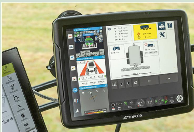
In der Topcon-Bedienung zeigt das Terminal die Sensormesswerte und die Sollmengen.
