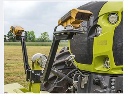
Der vorne angebaute CropSpec-Sensor misst den Stickstoffbedarf der Pflanzen.
