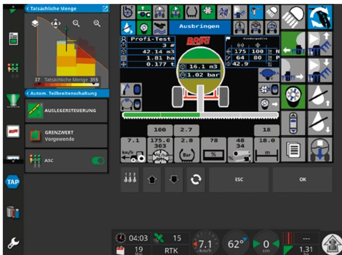
Die Briri-Bedienung zeigt in einer kleinen Tabelle die Soll- und Ist-Werte der automatischen Mengenregelung mit NIRS.
