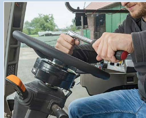
Das Topcon-Lenkrad mit flachem Elektromotor ersetzt hier das Originallenkrad eines Case IH Maxxum 130. Fotos: Tovornik
