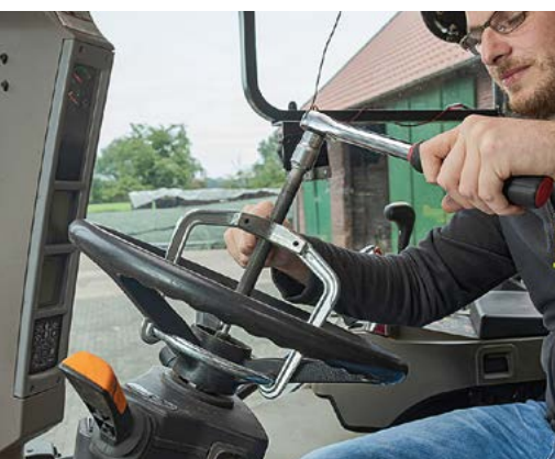
Mit einem Spezialabzieher zogen wir das Originallenkrad von der Lenksäule.
