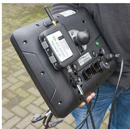
Das GSM-Modem ist an der Rückseite der Bedienkonsole befestigt.
