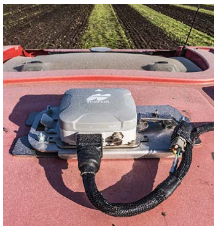
Der GNSS-Empfänger AGS-2 ist auf einer Schnellwechselplatte montiert.
