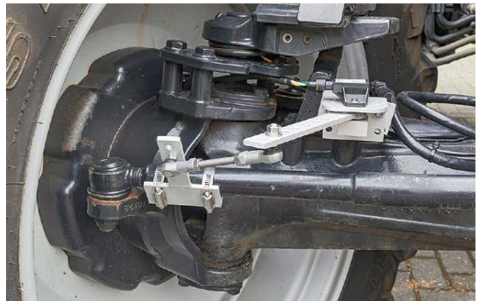
Der Lenkwinkelsensor erkennt, in welche Richtung der Schlepper lenkt.
