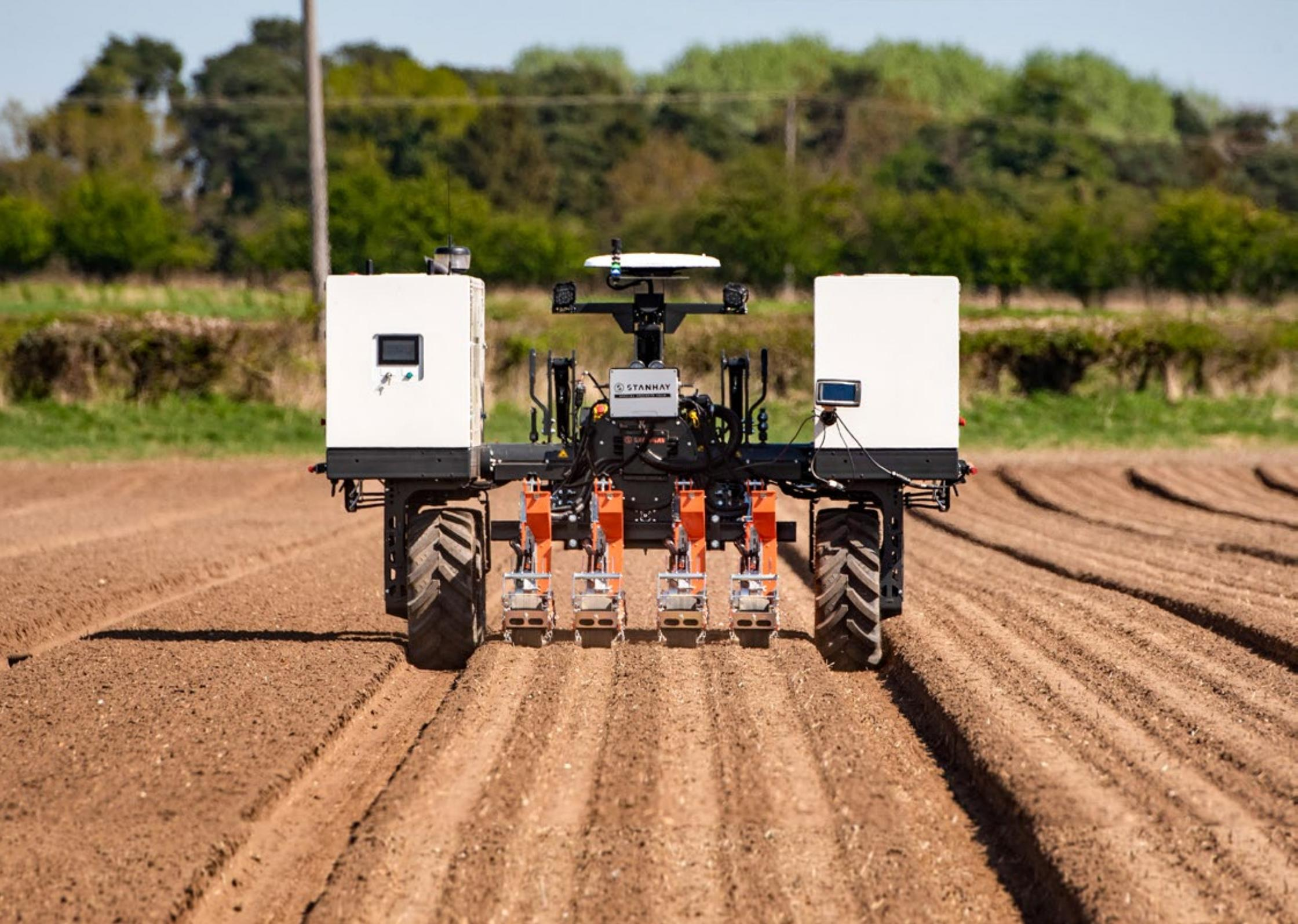
AGROINTELLI ist ein 2015 gegründetes dänisches Unternehmen, das sich auf Feldroboter spezialisiert hat. Die Konstruktion des ROBOTTI LR nach dem Gantry-Prinzip mit Zwischenachsenbau hat entscheidende Vorteile bei der Feldarbeit vor allem in Reihen- und Beetkulturen.
