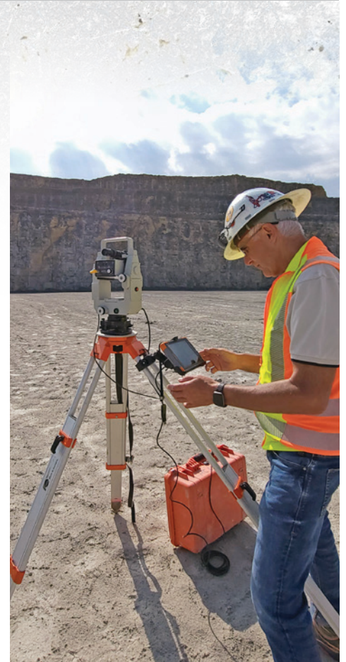
Ein Bergbauspezialist plant eine Sprengung mit der QuarryX-Software, die auf dem Mesa Rugged Tablet läuft.
