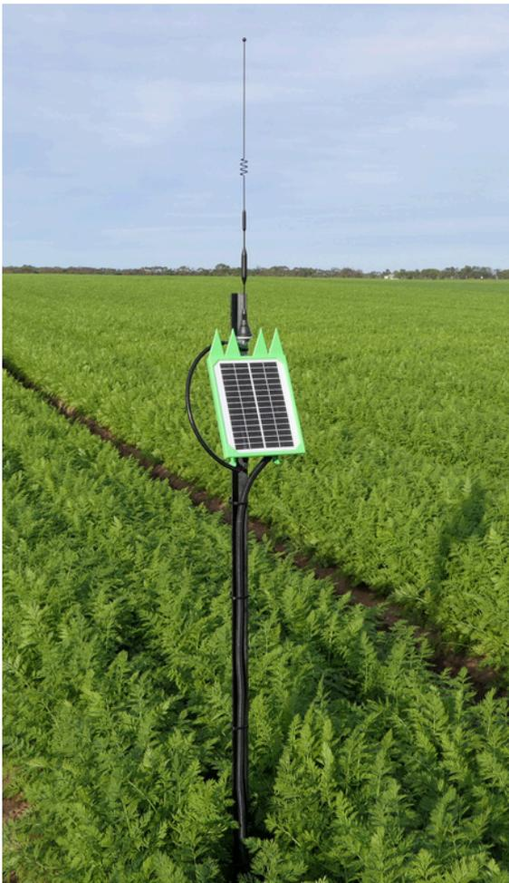
Die Sentek IoT DTU ist eine effiziente, kostengünstige Datenübertragungseinheit (DTU), die in Verbindung mit einer Sentek Drill & Drop-Sonde eine Verbindung zur IrriMAX Live-Cloud-Plattform von Sentek herstellt und dabei die neueste Low-Power-Mobilfunktechnologie nutzt. In Verbindung mit einer Drill & Drop Sonde ermöglicht die IoT DTU eine schnelle Installation und das gesamte System ist in wenigen Minuten einsatzbereit.
