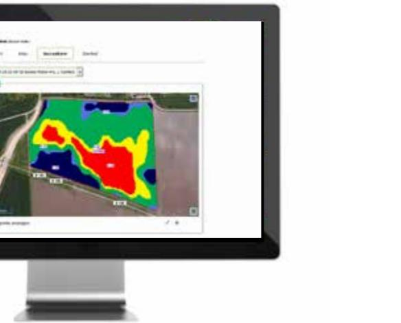
abzudecken und präzise zu vermessen. Mit Hilfe von coGIS lassen sich die generierten Daten automatisiert verarbeiten und auswerten. So können selbstständig Vegetationsindizes berechnet und diese schnell und einfach in Zonen- und Applikationskarten umgewandelt werden. Letztere können direkt auf das automatische Lenksystem des Schleppers vor Ort übertragen und damit eine teilflächenspezifische Applikation von Saatgut, Dünger etc. gewährleistet werden.
